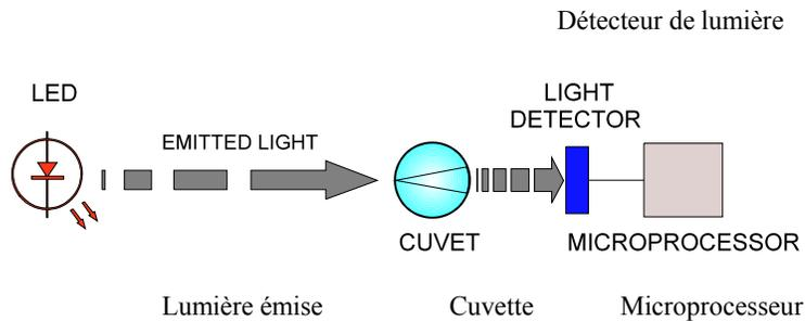
Une diode électroluminescente monochromatique (Led) émet un rayonnement à une longueur d'onde unique éclairant le système avec une intensité lumineuse  $I_0$ .
